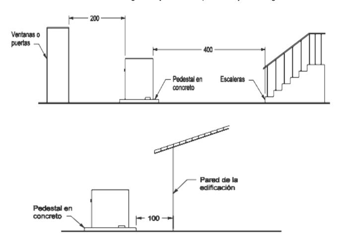
El transformador se ubicará sobre una base o pedestal de concreto lo suficientemente nivelada para evitar una inclinación mayor a 1.5°, ya que al modificar el nivel de aceite se puede ocasionar una falla disruptiva.
