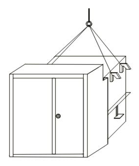
Para ser deslizado por medio de gatos estibadores evite apoyarse en las caras del transformador ya que estas no fueron diseñadas para soportar este tipo de esfuerzos.
